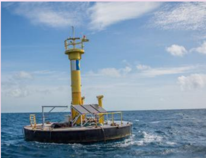
La boya del hábitat Aquarius suministra electricidad, aire y comunicaciones.
